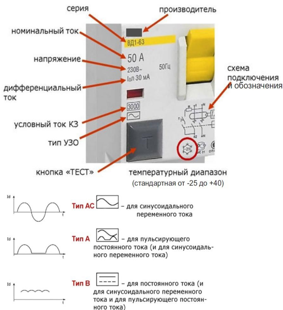
Рисунок 5. Маркировка УДТ
